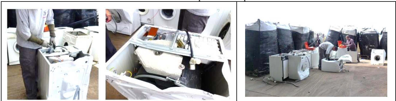
Foto 1: Detalle de extracción manual previa de componentes de una lavadora.
