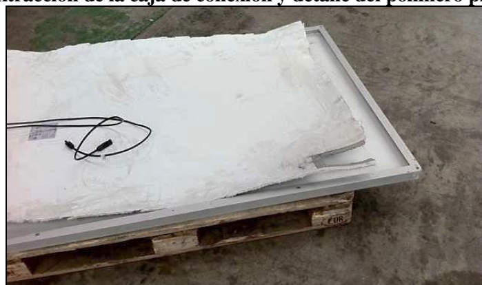
Foto 29: Extracción de la caja de conexión y detalle del polímero plástico EVA.
