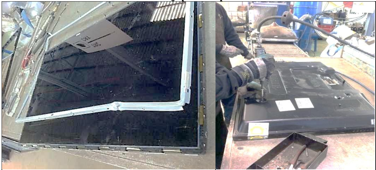
Foto 17: Desmontaje previo de pantallas LCD.
