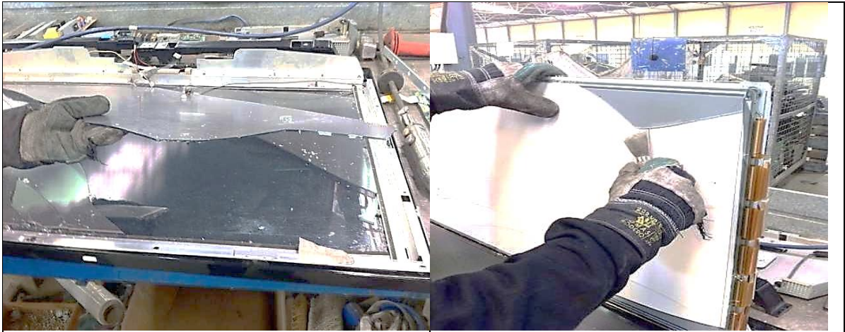
Foto 20: Extracción de las láminas de vidrio.
