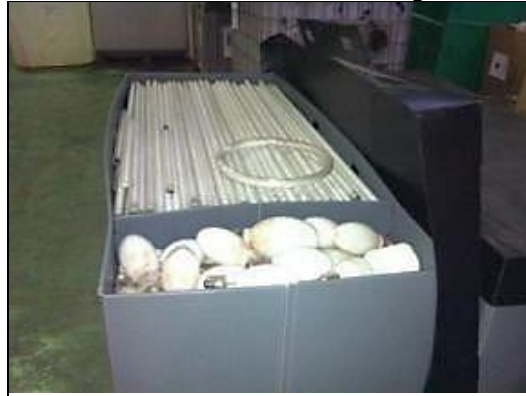
Foto 21: Detalle de un contenedor de lámparas de descarga.
