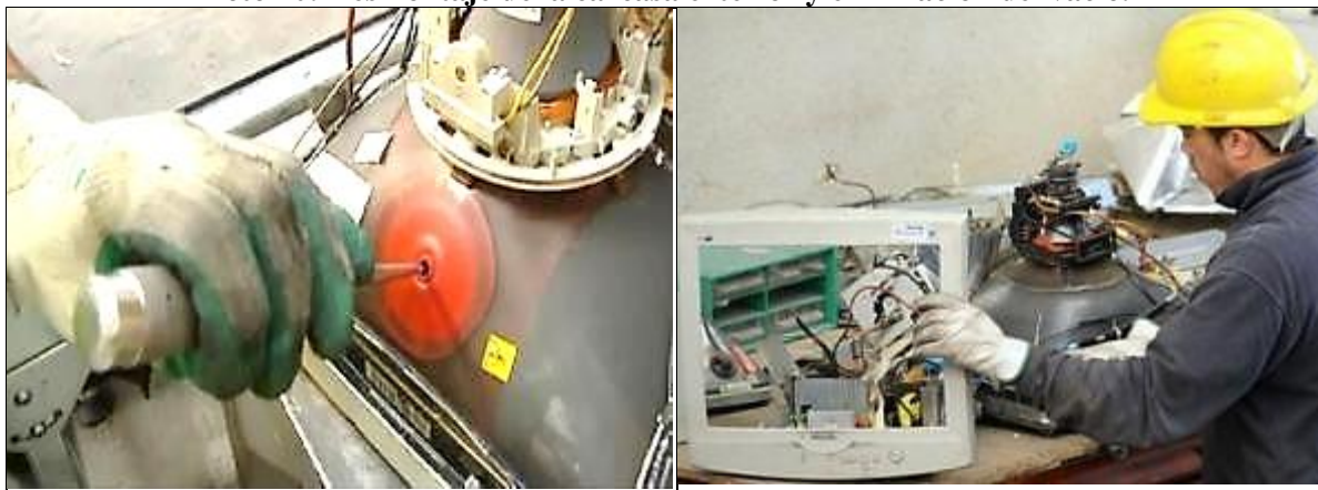
Foto 10: Desmontaje de la carcasa exterior y eliminación del vacío.
