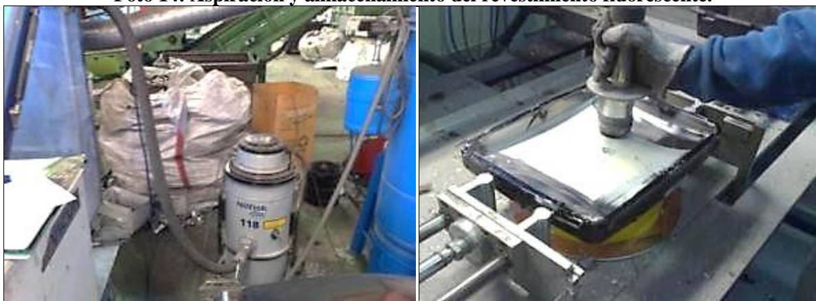
Foto 14: Aspiración y almacenamiento del revestimiento fluorescente.
