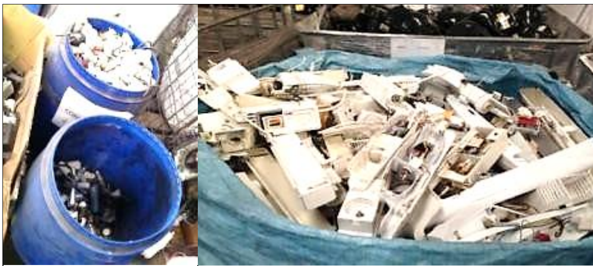
Foto 9: Detalle de la segregación de componentes extraídos durante el proceso de tratamiento.
