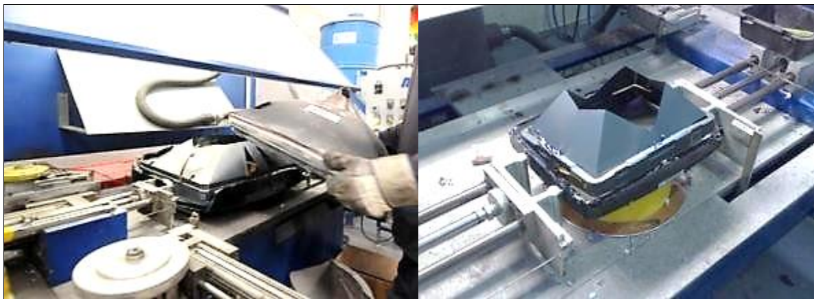
Foto 14: Aspiración y almacenamiento del revestimiento fluorescente.
