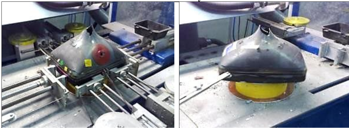
Foto 12: Marcado del vidrio y rotura térmica.
