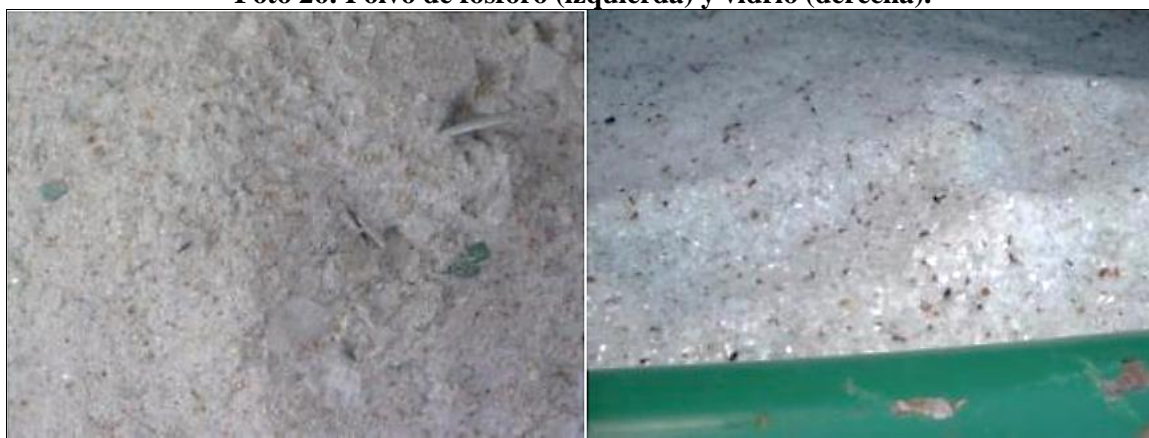
Foto 26: Polvo de fósforo (izquierda) y vidrio (derecha).
