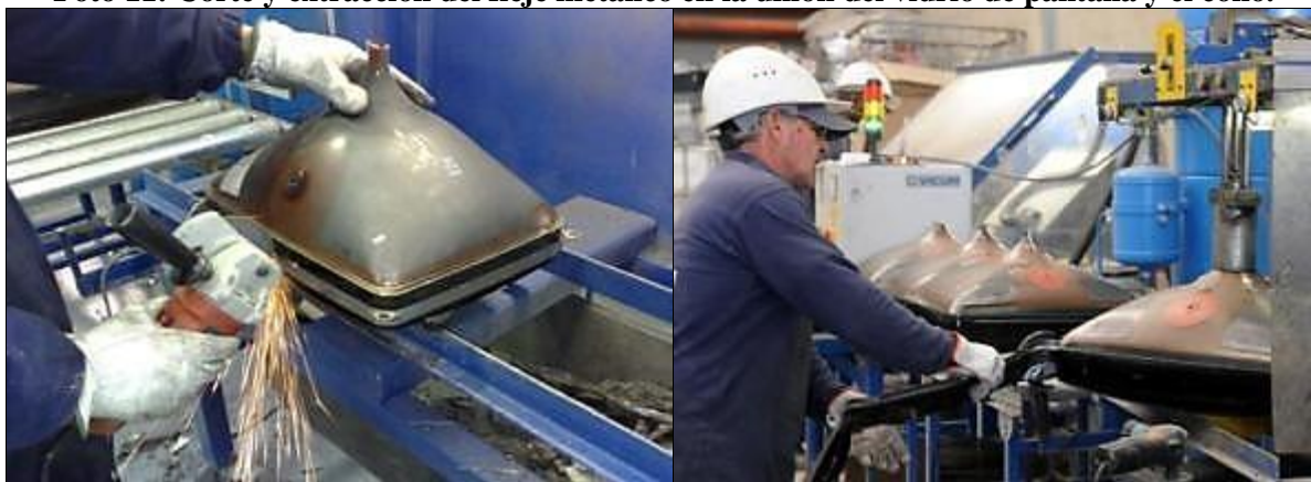
Foto 11: Corte y extracción del fleje metálico en la unión del vidrio de pantalla y el cono.
